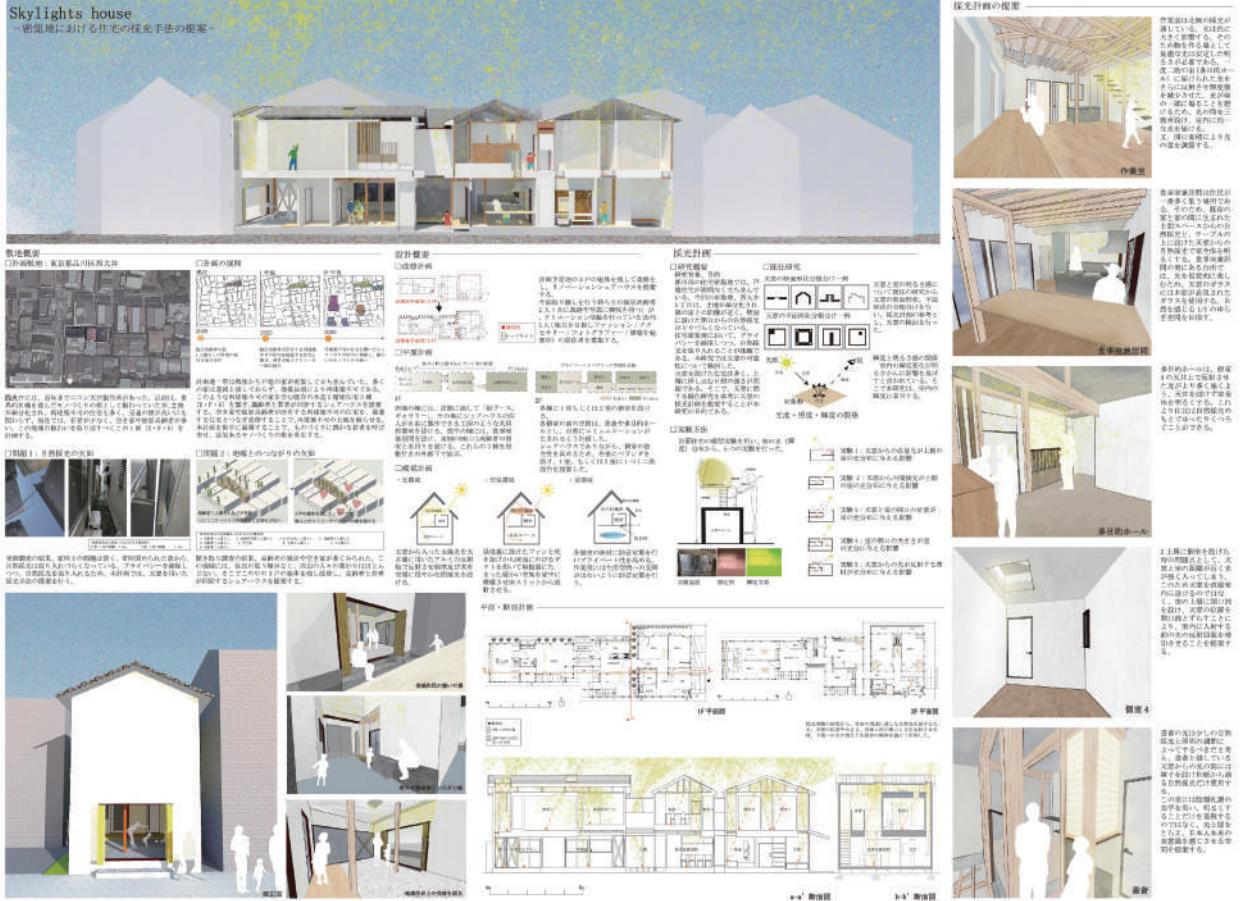
品川区西大井は、かつて、ものづくりの街として賑わったが、細分化した土地に再建築不可の家が点在し、現在は独居高齢者が多い。本計画は、西大井にある再建築不可の家を含む既存の木造2階建住宅3棟を繋ぎ、高齢者と若者が同居するシェアハウスを提案する。住宅密集地においてプライバシーを確保しつつ自然採光を取り入れるため、模型を用いた5つの実験を行い、天窓からの採光手法の検討を行った。上階の室にも穏やかな光が落ちるよう、天窓からの光を室の天井裏で反射させる。天窓の位置や大きさ、各室上部の開口と光を反射させる材、下階への光の筒などを既存の躯体を避けて計画した。本計画を街中に展開し、再建築不可の土地を蘇らせ、活気あるモノづくりの街を再生する。
